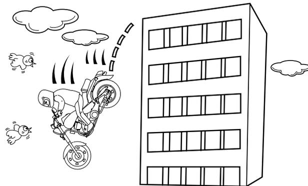
El aumento del impacto es proporcional a la velocidad y al peso. El impacto de una colisión con un muro de hormigón a 50 km/h es comparable al de una caída desde una altura de 10m.
