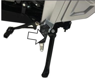
Para usar el caballete central, presiónelo con el pie y levante la parte de atrás de la motocicleta hasta que la rueda se levante. Para colocar el caballete lateral, bájelo con el pie hasta el final de su recorrido, apoye la moto sobre este punto.
