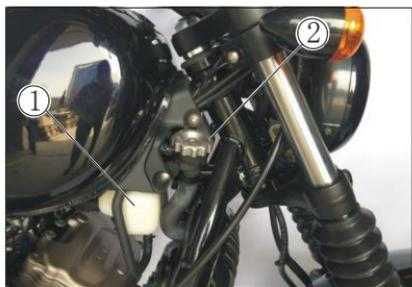
En el lado derecho del extremo delantero del vehículo se encuentra el vaso de expansión ① junto al tapón del radiador ②.
