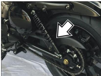
Para ajustar la precarga del muelle, deberá utilizar la llave y girar en sentido horario o anti-horario según el ajuste que usted desee.
