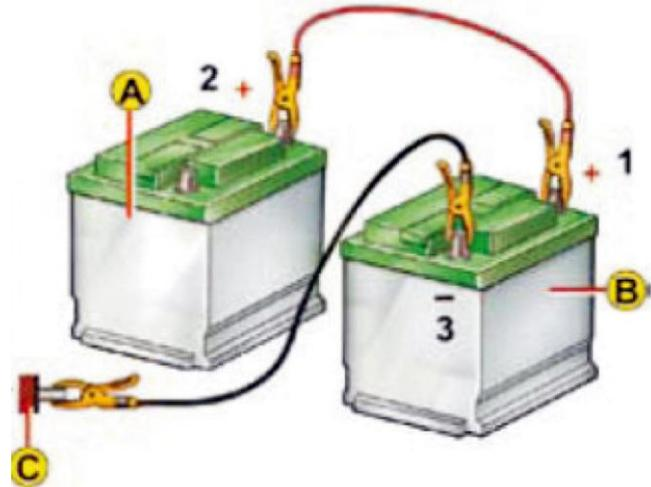
Antes de retirar la batería externa, el motor necesitará estar en funcionamiento unos minutos. Desconecte primero el terminal negativo y la conexión con el bastidor y luego los terminales positivos.
