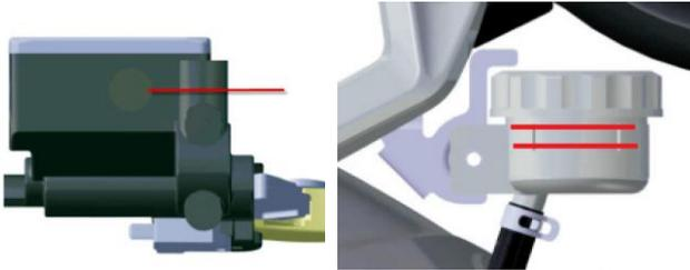
Compruebe si el nivel de líquido de frenos está por encima de la marca de nivel mínimo en el depósito de las bombas de freno delantera (izquierda) y trasera (derecha). En el caso de que el nivel se encuentre por debajo de la marca, necesitará añadir líquido de frenos, superando esta marca
