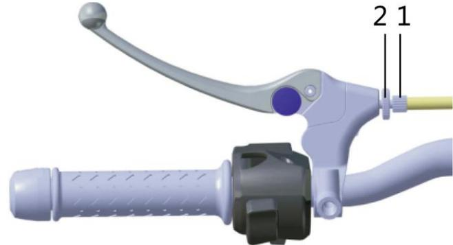
Cuando arranque el motor accione firmemente la maneta de embrague para separar los discos de fricción e interrumpir la transmisión.
