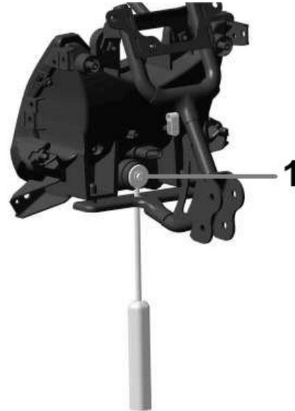
Con un destornillador de estrella actúe sobre el tornillo (1) de la parte posterior del faro
