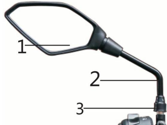
Ajuste los espejos retrovisores según su estatura y posición de conducción. El espejo (1) se debe ajustar a mano directamente. Afloje la tuerca (3) para regular el mástil del retrovisor (2) utilizando las herramientas de la dotación de la motocicleta. Finalmente, vuelva a apretar la tuerca (3).
