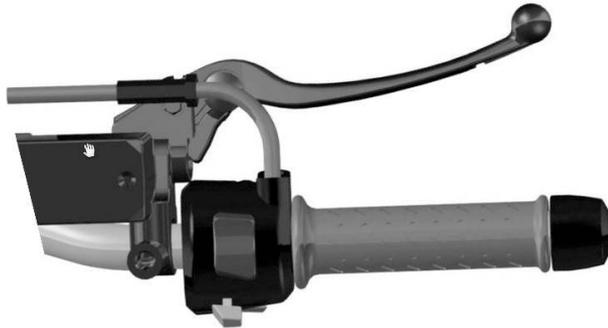
La maneta del freno delantero incluye un ajuste para regular la distancia entre la maneta y la empuñadura del acelerador.
