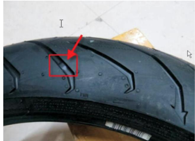
Los neumáticos cuentan con indicadores de desgaste en su superficie. Nunca se debe alcanzar el límite de desgaste. Los indicadores se encuentran cerca del logo del neumático en el extremo de la banda de rodadura. Cuando la superficie del neumático se engrasa con el indicador, se ha alcanzado el límite. Cambie el neumático.
