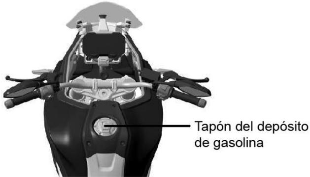
Para repostar abra el tapón del depósito de combustible introduciendo la llave de contacto en la cerradura del tapón y girándola a la derecha.
