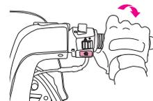
Coloque el vehículo sobre el caballete central, arránquelo y verifique que el puño del gas funciona correctamente al acelerar y decelerar.
