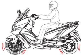
Conduzca el vehículo en una carretera seca y accione ambos frenos por separado para comprobar la eficacia de la frenada.
