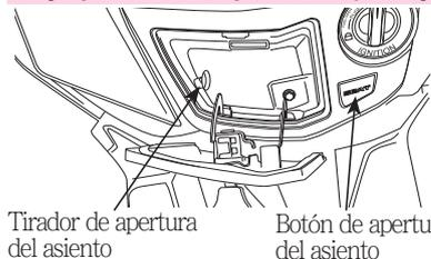
Si la Llave inteligente se encuentra a menos de un metro de distancia del vehículo, presione el botón de apertura del asiento y el asiento se abrirá. Pero en el caso que la batería del vehículo o la batería de la Llave Inteligente esté descargada o el asiento no se abra por razón de una zona de alta carga eléctrica, puede abrir el asiento utilizando el tirador de apertura del asiento que encontrará abriendo la guantera
