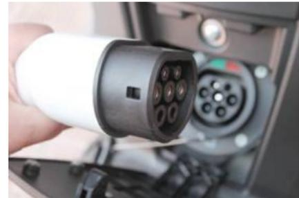
La carga de la batería de la moto se realiza conectando directamente a la red eléctrica. Para ello la moto, cuenta con una conexión tipo 2.
