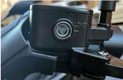
Con el scooter sobre su caballete central en una superficie llana, gire el manillar hasta que la bomba de frenos, cuyo nivel va a comprobar, quede en horizontal. A través de la mirilla del depósito de la bomba, compruebe que el nivel de líquido de frenos se encuentra por encima de la marca "LOWER".
