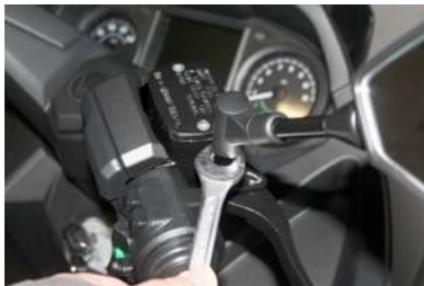
Libere la contratuerca de la base del mástil del retrovisor con una llave fija de 14 mm, y oriente el mástil con el manillar recto de manera que quede perpendicular al eje longitudinal del vehículo (no paralelo al manillar) para conseguir el punto más alejado de los espejos.
